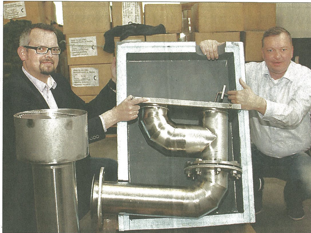
Andreas Böckmann (links) und Stephan Neitzel präsentieren den Prototyp eines neuartigen Überdruckventils für Biogasanlagen.
