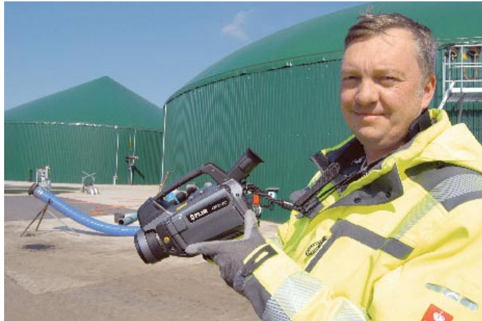
Teurer als ein guter Trecker: An die 100.000 € kostet die Gaskamera, mit der Stephan Neitzel europaweit Leckagen an Biogasanlagen aufspürt.
