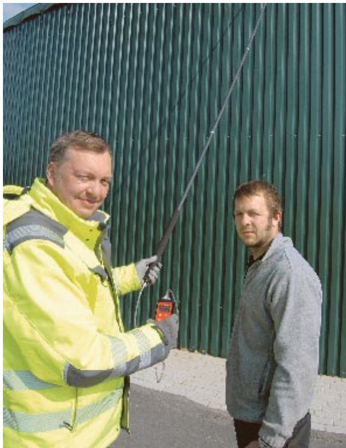
Nachdem mit der Gaskamera das Leck geortet wurde, stellt Stephan Neitzel (links) bei Landwirt Axel Iben mit dem Gasspürgerät die Konzentration des Gases fest.
